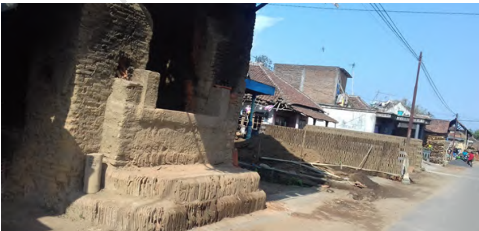
Proses pengeringan batu bata rumahan sebelum dimasukkan dalam tempat pembakaran di Malang
